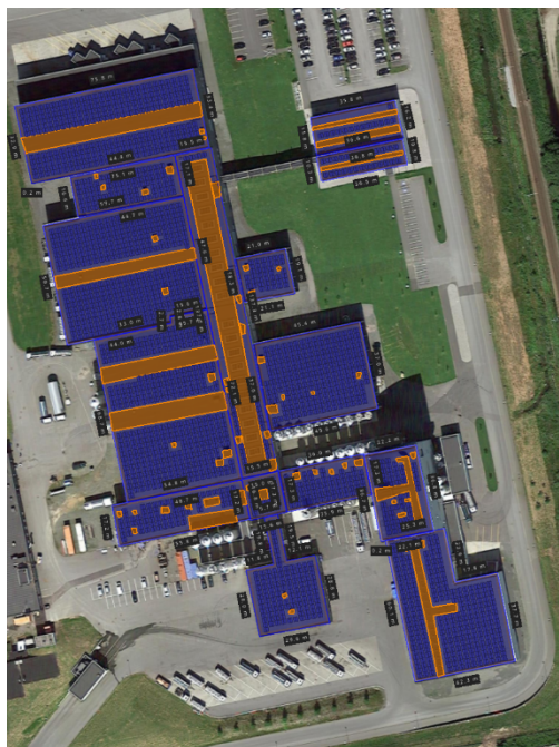
Figur 19 Solcellemoduler lagt på tak for en bygning i kategorien industri. Det oransje området viser bebyggelse på taket som er utelatt fra studien. Dette bygget har en total arealutnyttelse på 40%.
