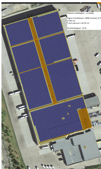
Figur 7 Solcellemoduler lagt på tak for en lagerbygning. Det oransje området viser bebyggelse på taket som er utelatt fra studien. Bygget har en total arealutnyttelse på 65%.
