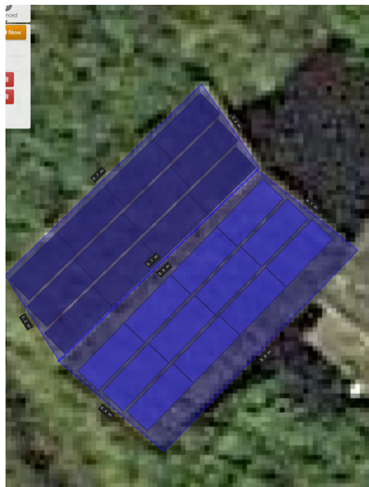
Figur 40 Solcellemoduler lagt på et lite landbruksbygg. Dette taket har ingen takstruktur. Total arealutnyttelse er 66%.
