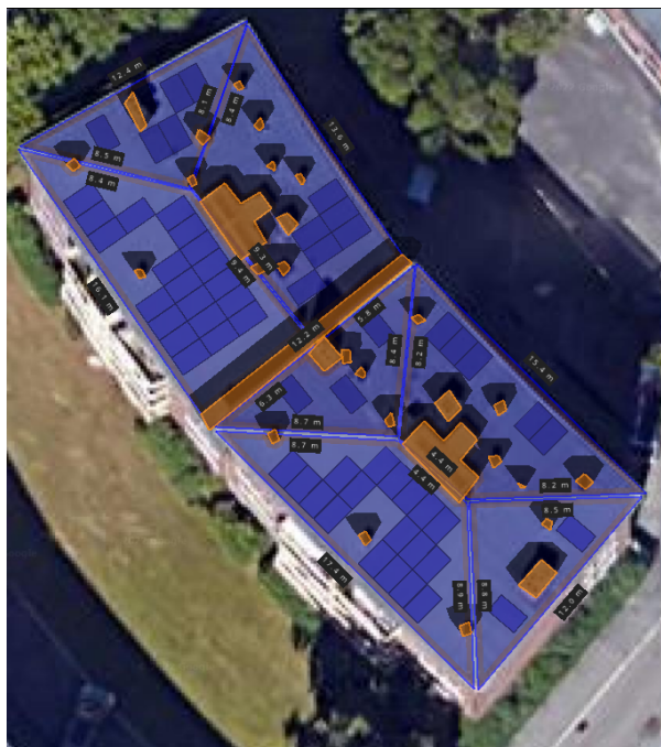
Figur 34 Solcellemoduler lagt på tak for en blokk på 3-4 etasjer. Det oransje området viser bebyggelse på taket som er utelatt fra studien, her synes også skyggeeffekten av objektene på taket. Dette bygget har en total arealutnyttelse på 30%.
