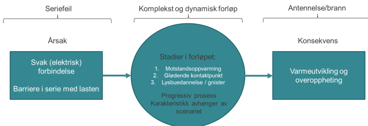
Figur 2: Skisse som illustrerer forløpet fra en seriefeil oppstår (årsak) til en brann bryter ut (konsekvens).
