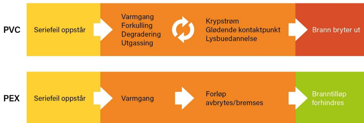
Figur 12: Seriefeilforløp for en PVC- og PEX-isolert elektrisk kabel. Forløpet avbrytes, og branntilløpet vil kunne forhindres i tilfellet for PEX.
