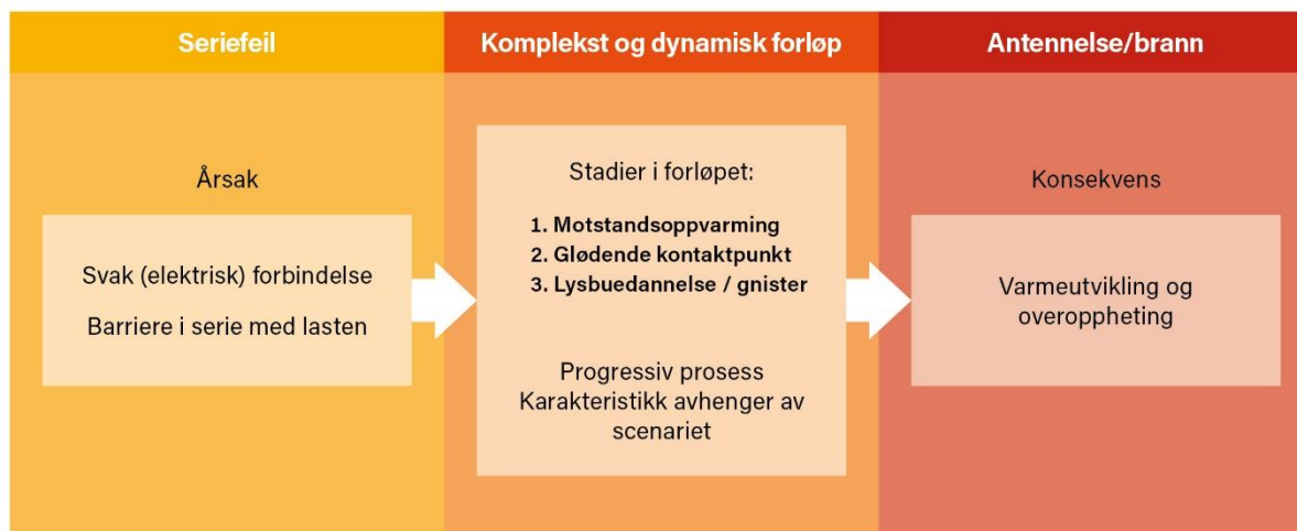
Figur 3: Illustrasjon av forløpet til en seriefeil fra dannelsen av en svak elektrisk forbindelse (årsak) til utvikling av en brann (konsekvens) [10].
