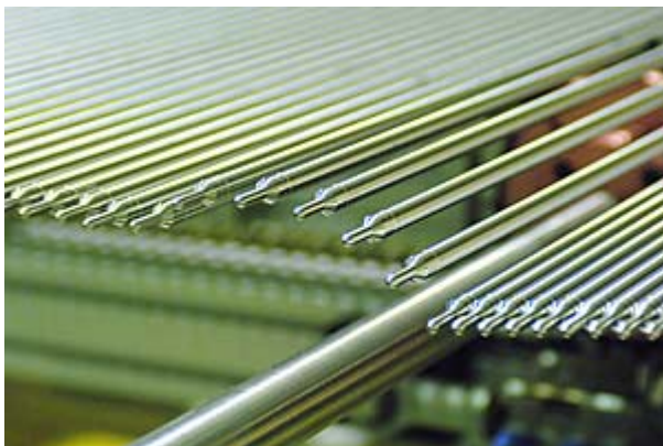
Figur 5: Ferdige brenselstaver i et brenselproduksjonsanlegg. Foto: D. Calma/IAEA
