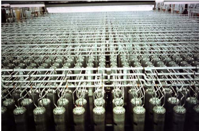
Figur 4: En kaskade med sentrifuger i anlegget ved URENCOs urananrikingsanlegg Almelo i Nederland. Foto: C. severin Uranit-Werkefoto, 1981
